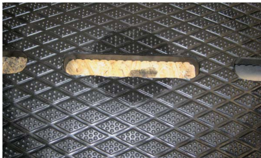
Bild 4: Bodenbelag nach der Dauertrittbelastung
