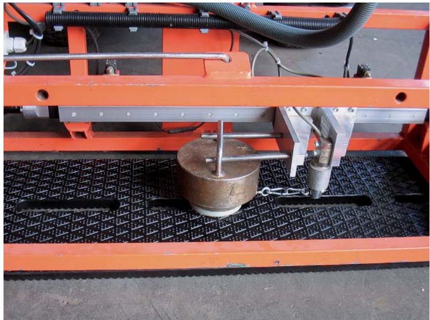
Bild 5: Messung der Rutschfestigkeit
